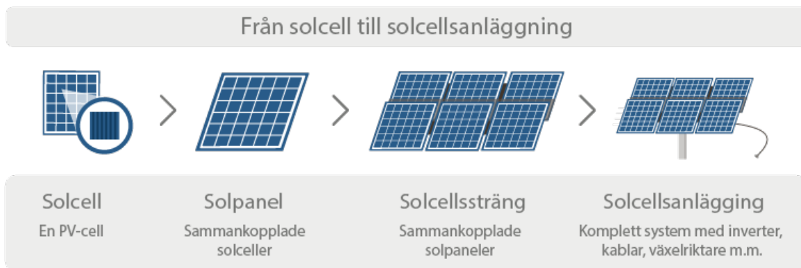
Figur 2.7: Närbild på hur en solcellsanläggning är uppbyggd av flera solceller [41].
